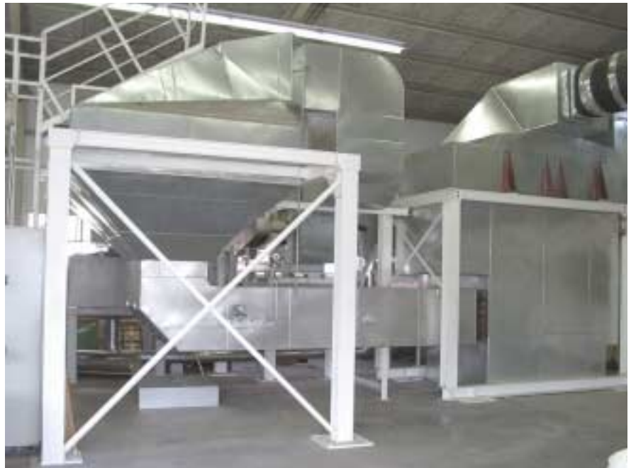
Bild 1: Anlage zur plasma-katalytischen Abluftreinigung
