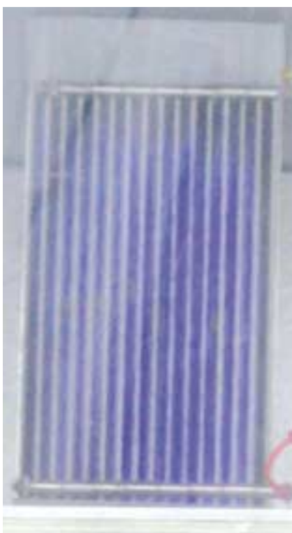
Bild 4: Plasmamodul mit dielektrisch behinderter Entladung in einem Gasstrom. Die elektrische Entladung ist an dem violetten Leuchten zu erkennen.
